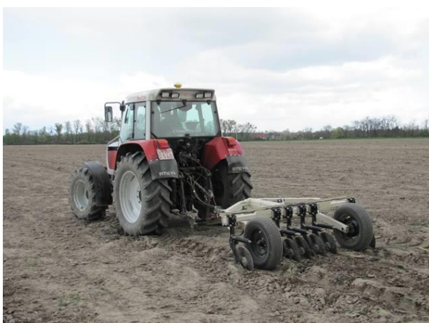
5-6. fotó. Veris 3100 talaj fajlagos elektromos vezetőképesség-mérés
