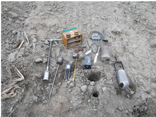
1-2. fotó. Bolygatatlan talajminta-vétel gravimetrikus nedvesség-meghatározáshoz
