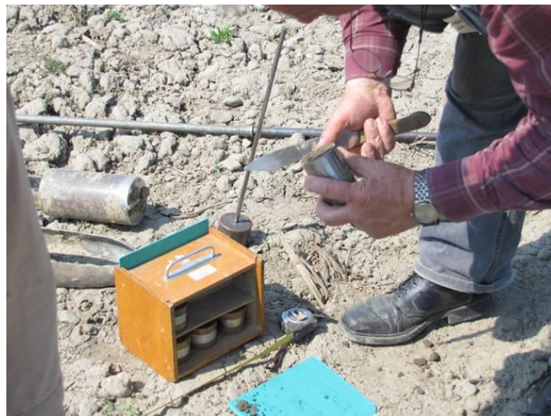
1-2. fotó. Bolygatatlan talajminta-vétel gravimetrikus nedvesség-meghatározáshoz
