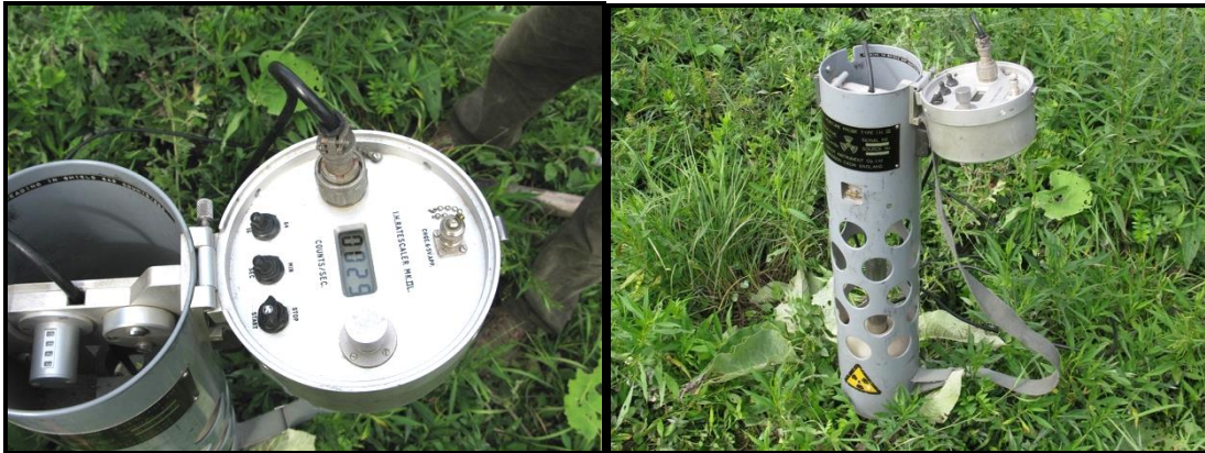
4. ábra Talajnedvesség-meghatározás neutronsóródásos módszerrel (Forrás: Csiba, 2010 )
