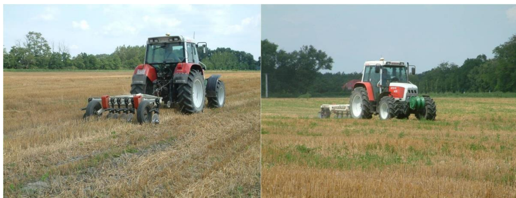
20. ábra A Veris 3100 fajlagos vezetőképesség mérő használat közben
