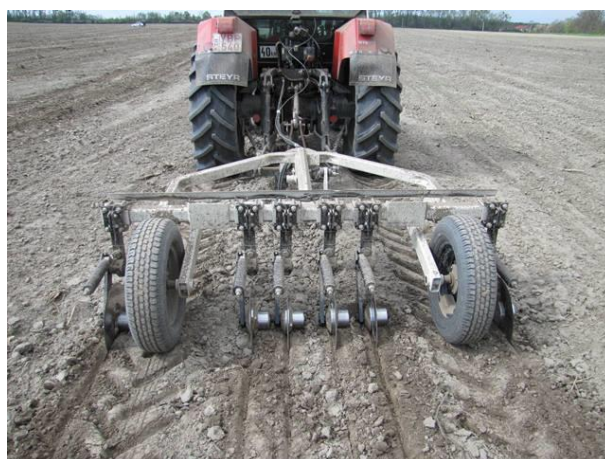
5-6. fotó. Veris 3100 talaj fajlagos elektromos vezetőképesség-mérés
