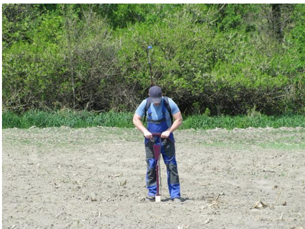
3-4. fotó. TDR-300 volumetrikus talajnedvesség-mérés
