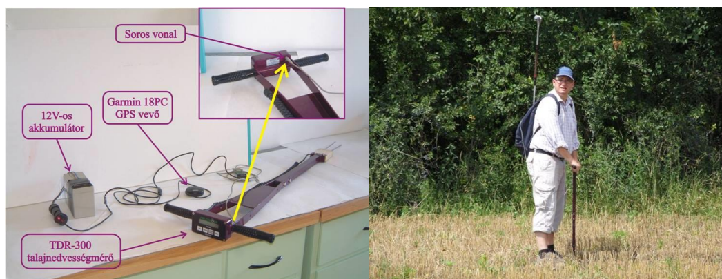
18. ábra A Spectrum TDR-300 talajnedvesség mérő felépítése és alkalmazása
