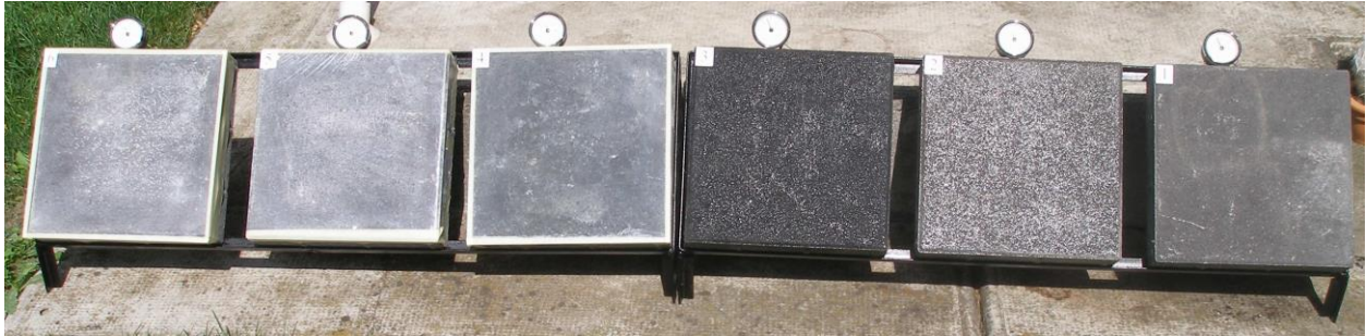
3.8. ábra Felületi hőmérséklet mérés elrendezés
