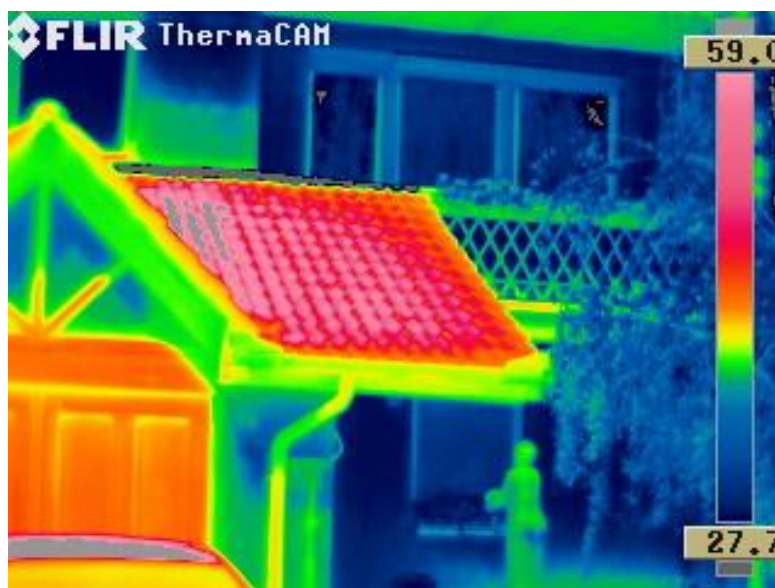
3.16. ábra Betoncserép tetőfelület hőmérséklet eloszlása
