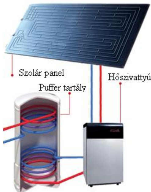
2.16. ábra Szolár hőszivattyús rendszer
