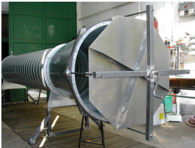
3.15. ábra: Diffúzor fojtólappal
