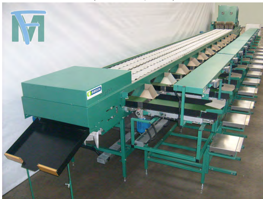
2.6. ábra A csészék a termés kibillenésének veszélye miatt lassan mozgathatók, a megfelelő teljesítmény elérése miatt többsoros kialakítás (HORTIMAT, 2012b)
