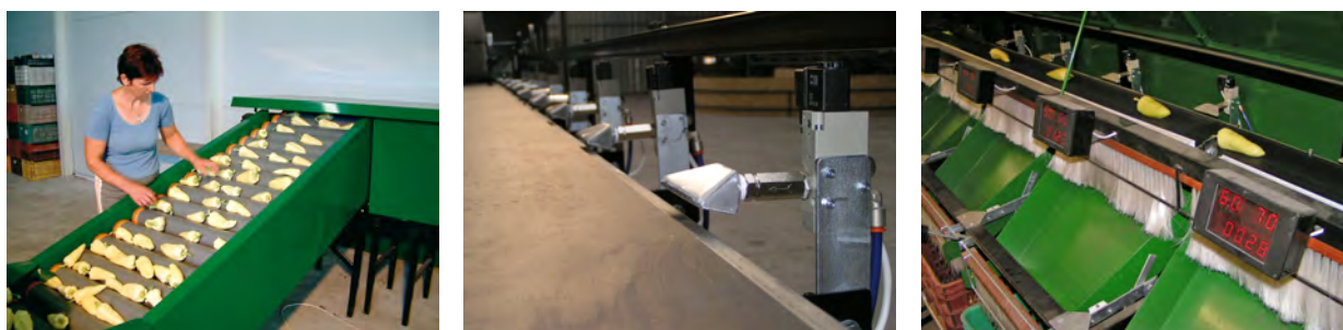
3.15. ábra A termésrendezési rendszer (balra), a sűrített levegős termésválasztás (középen és jobbra) (Tömpe, 2007)
