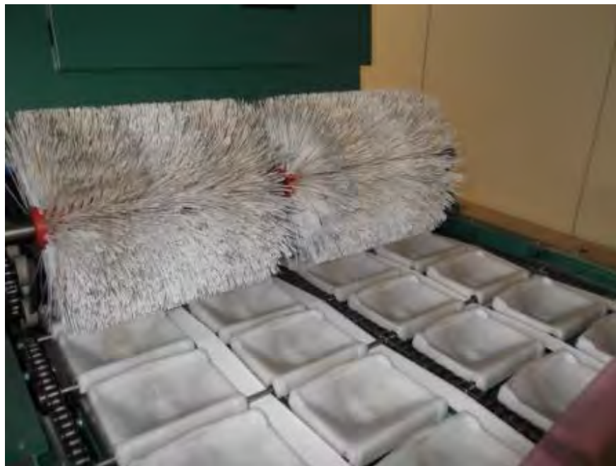
2.5. ábra Tömeg szerinti válogatásra alkalmas, terméscsészés rendszer (HORTIMAT, 2012a)
