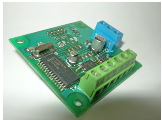
3.10. ábra A saját fejlesztésű, a vonal CCD képadatainak fogadását végző áramkör
