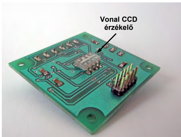
3.10. ábra A saját fejlesztésű, a vonal CCD képadatainak fogadását végző áramkör
