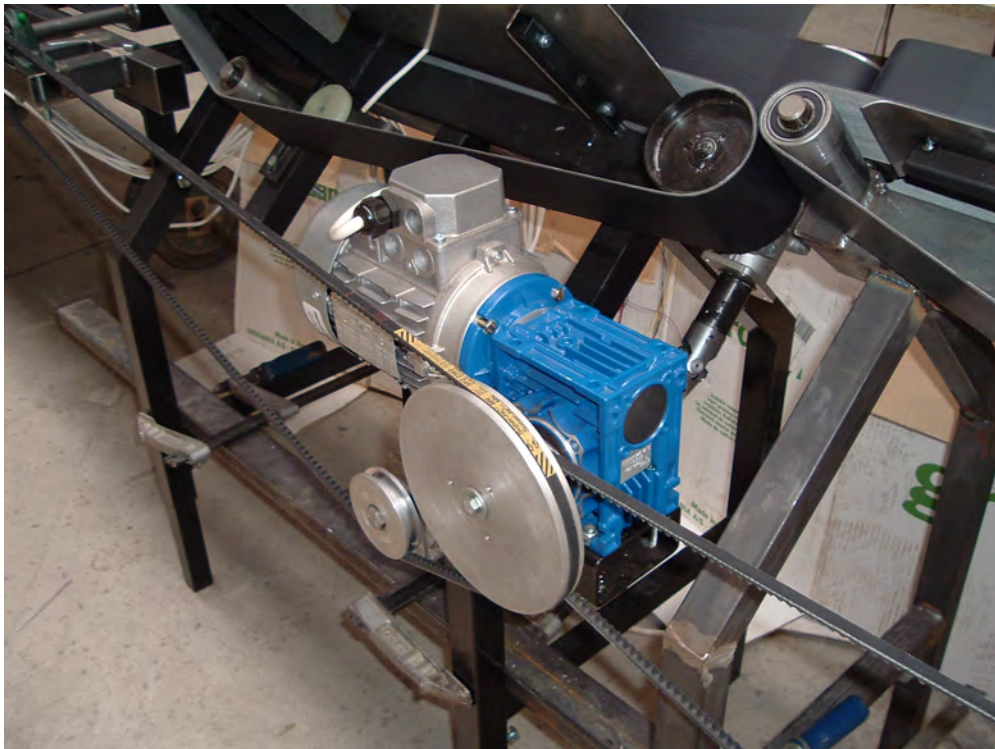
3.4. ábra A szállítószalagok mozgatása hajtóműves, háromfázisú aszinkron motorokkal történik
