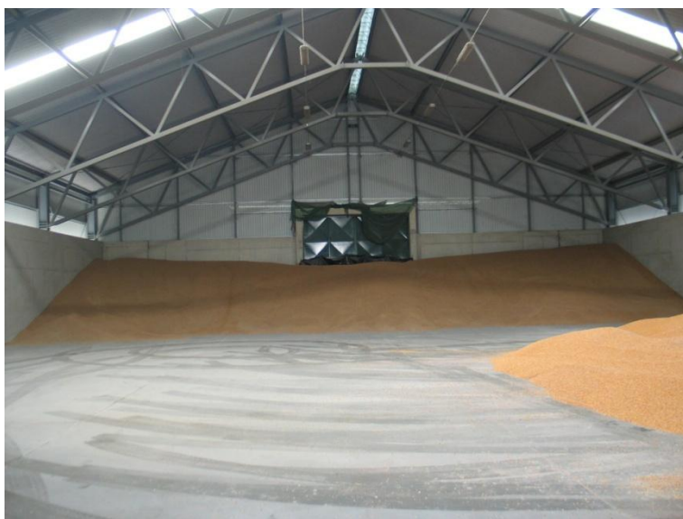
50. ábra Siktároló, betárolás teleszkópos rendszerrel történt.
