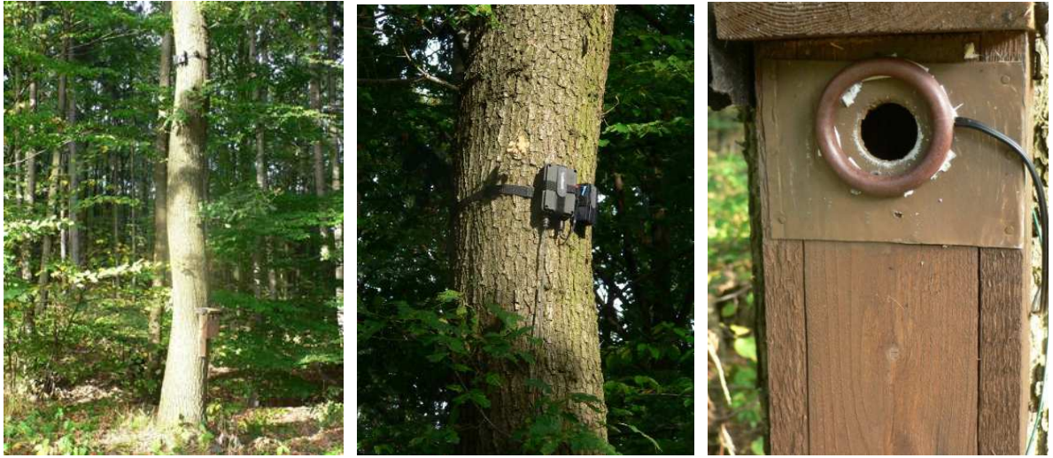
21. kép. Folyamatos megfigyelőrendszer chip leolvasóval és memóriaegységgel (PETER ADAMÍK felvételei)
