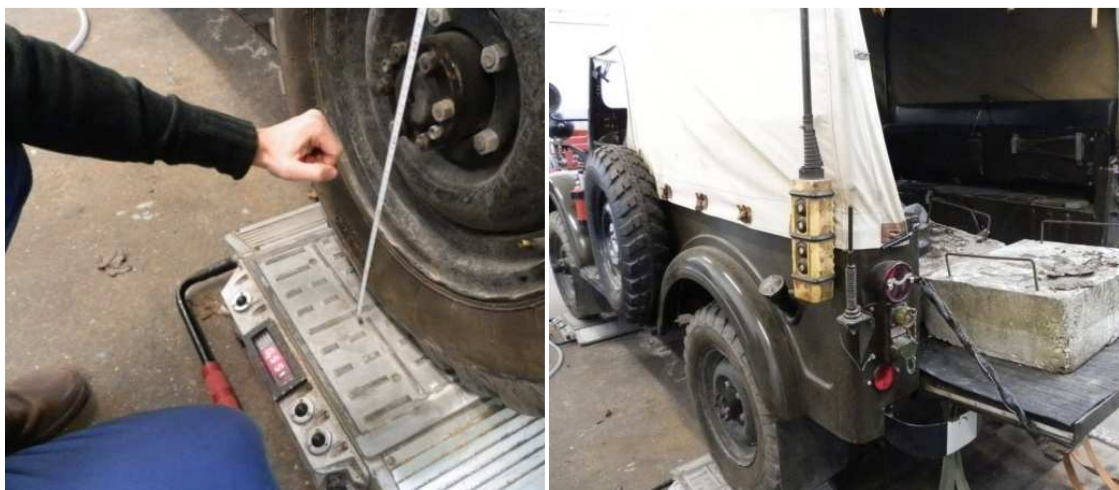
3.4. ábra Rugómerevség meghatározás, a) kerék középpontjának és a talaj távolságának felvétele, b) többletterhelés a vizsgált abroncson
