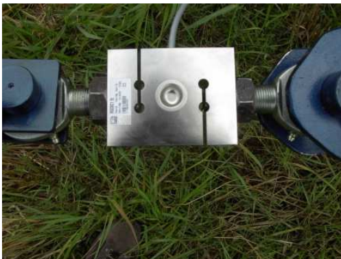
3.10. ábra Erőmérő cella, 50 kN
