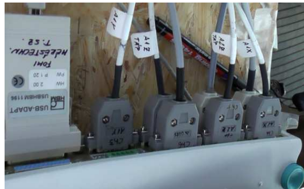
3.11. ábra Spider-8 típusú adatrögzítő bekötése
