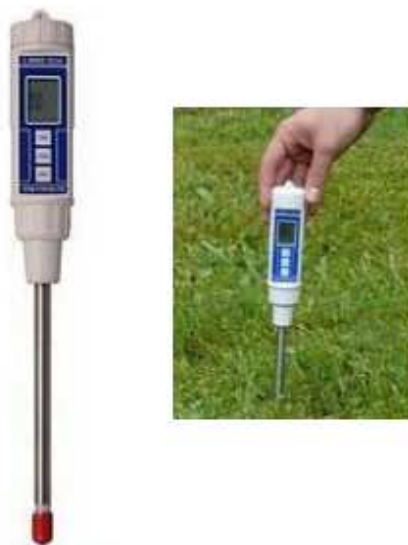
3.7. ábra PCE-SMM 1 talajnedvesség mérő
