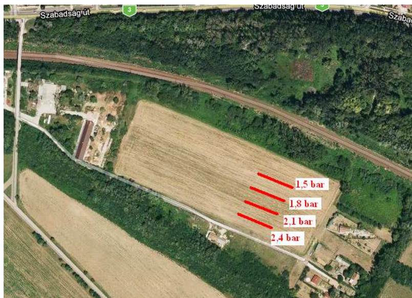
3.2. ábra A talajon történt vontatás helyszín rajza, a vontatási szakaszokkal és a szakaszokon alkalmazott abroncsnyomásokkal
