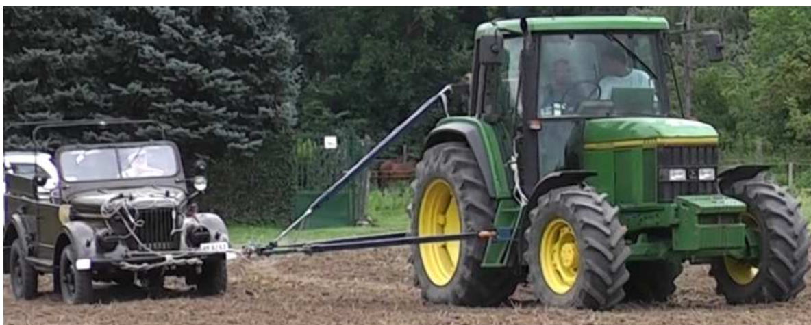
3.1. ábra A vizsgálathoz használt járműszerelvény, vontató jármű: John Deere 6600, vizsgált jármű: Gaz 69
