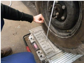
2.2. ábra Rugómerevség meghatározás, a) kerék középpontjának és a talaj távolságának felvétele, b) többletterhelés a vizsgált abroncson
