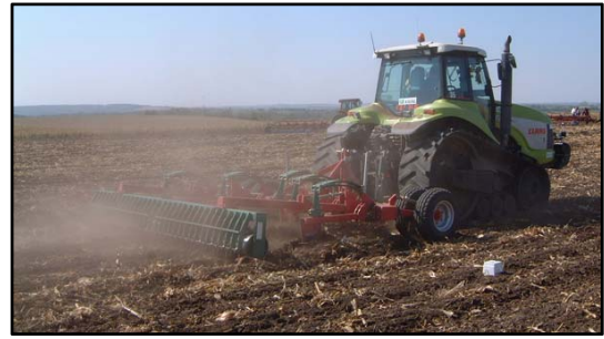
3.4. ábra. Kverneland CLE lazító
