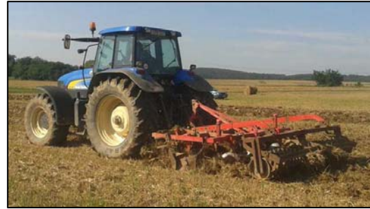
3.13. ábra. Pöttinger Synkro szántóföldi kultivátor, egyedi rögtörő hengerrel
