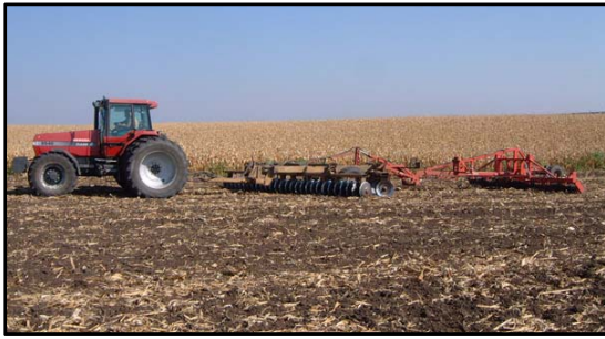
3.3. ábra. Rába IH770 tárcsás borona + Güttler henger
