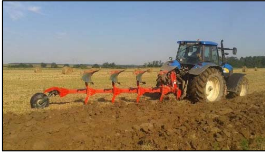
3.12. ábra. Vogel&Noot ©plus XM váltvaforogató eke
