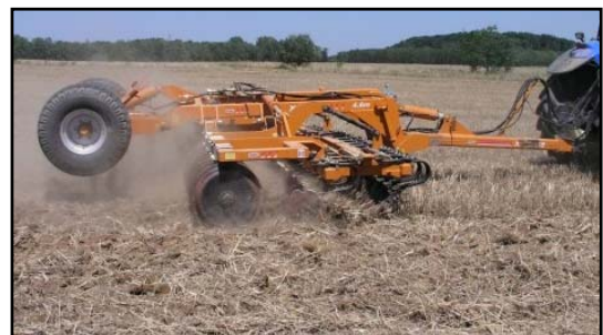
3.11. ábra. Symba X-press tárcsás borona
