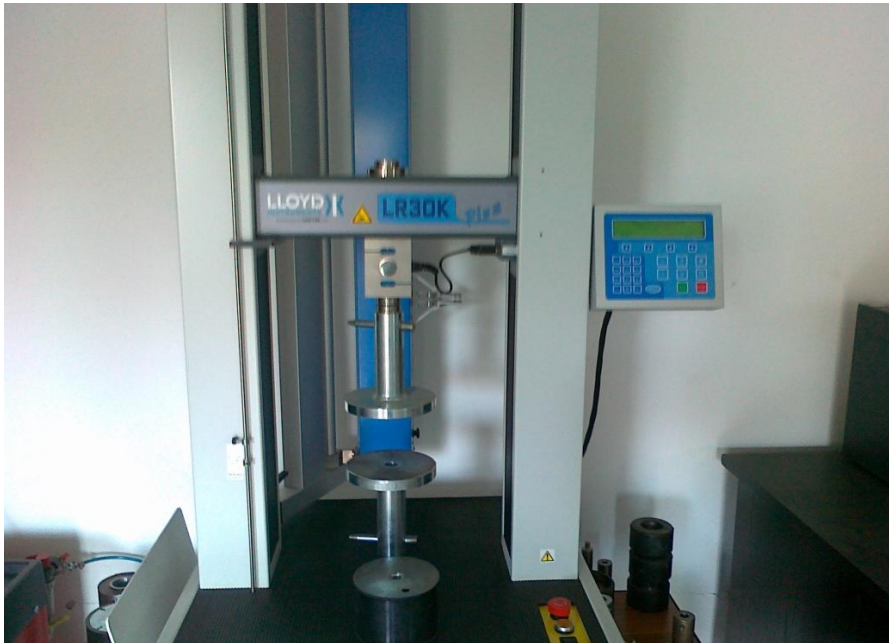
97. ábra. Statikus szakítógép
