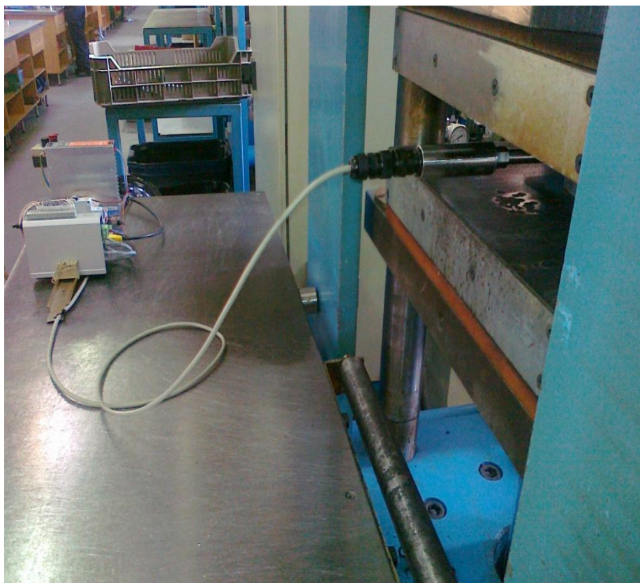
62. ábra. A préstechnológiával végzett szerszámüregi nyomásmérés
