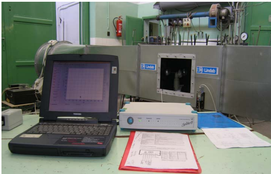
3. ábra Anemométer hitelesítés a gyakorlatban
