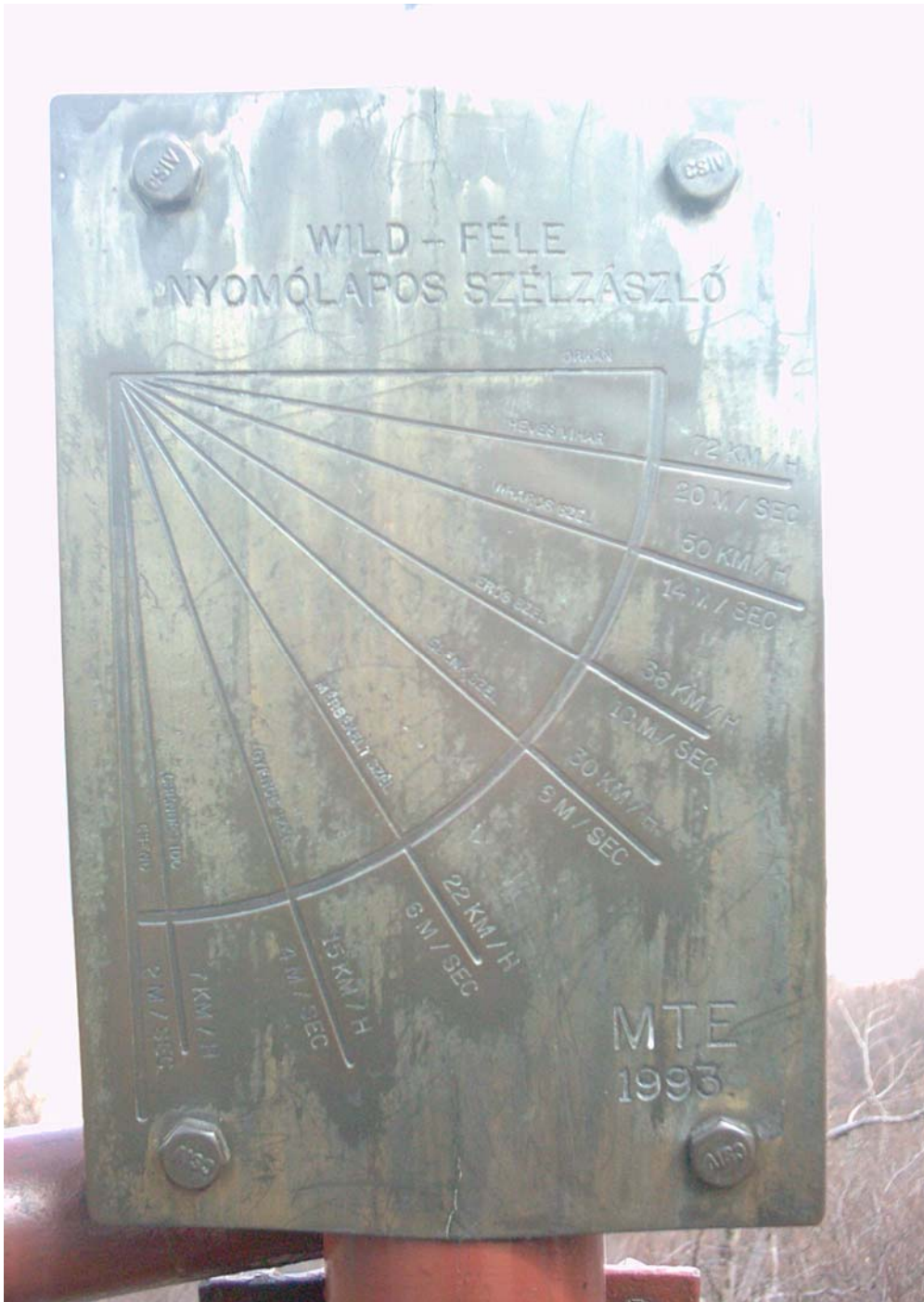
1. ábra A Wild féle nyomólapos szélmérő skálái (Dobogókő)
