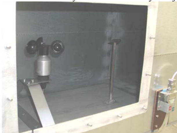
3.3. ábra A kanalas szélességmérő ellenőrzésére alkalmas csatornaelem és benne a Pradtl-Pitot cső elhelyezkedése
