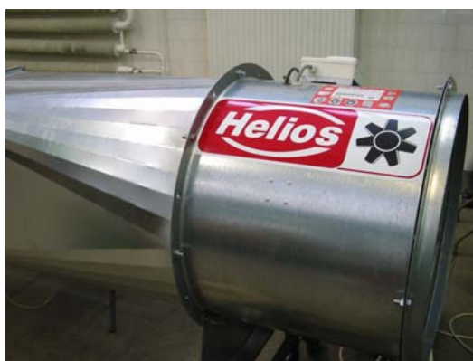
3.5. ábra Helios HRFD 63/4 típusú Ø630 mm-es axiál ventillátor
