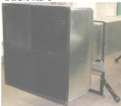
3.2. ábra A méhsejtszerű áramlásegyenletesítő
