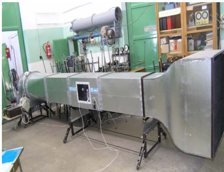
3.19. ábra Szélcsonna a SZIE-GÉK tanműhelyében (műszaki tervező: Szlivka Ferenc – Balló Béla) (forrás. saját kép)
