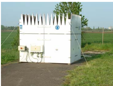
4.23. ábra Az összeszerelt SODAR (forrás: OMSZ)
