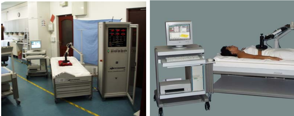
30. ábra. Mérési elrendezés tisztán ohmikus műterheléssel és reális paciennsel.
