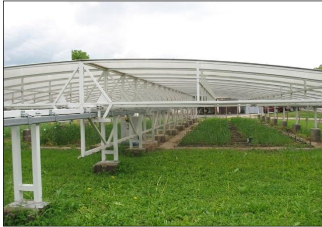
9. ábra. Az esővédő polietiléntetővel rendelkező kísérleti terület (Martonvásár, 2014)
