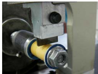
3.24. ábra. A súrlódási vizsgálatához befogott kerámia és acél próbatestek
