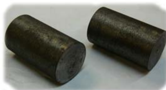
3.2. ábra. A forgácsolási vizsgálatban szereplő öntöttvasak lemezgrafitos (GJL 200) és gömbgrafitos (GJS-400-15)
