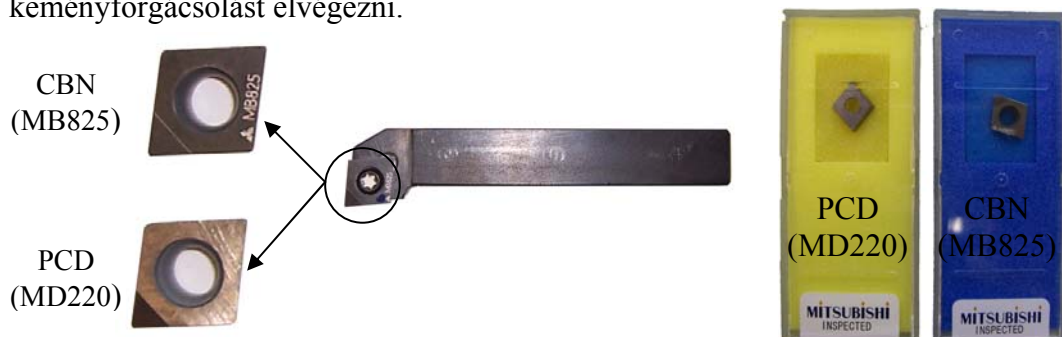
3.4. ábra. A vizsgálathoz használt esztergakés és lapkák gyémánt (PCD) és köbös bórnitrid (CBN)
