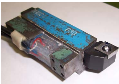
3.18. ábra. Az elkészült mérő-szerszámtartó fényképe a befogott tartóval
