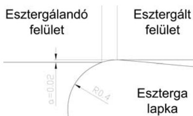
3.11. ábra. Szerszám csúcscsúgár menti érintkezése
