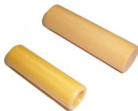
3.1. ábra. A vizsgálatokban szereplő kerámiák cirkóniumdioxid (ZrO 2 )
