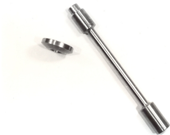
3.10. ábra. Normál irányú kötőszilárdság mérésénél alkalmazott próbatest
