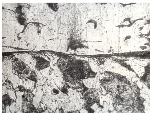
4.5. ábra. HardTec 19400 jelű porral szórt réteg és átmeneti zóna, (N 500x)
