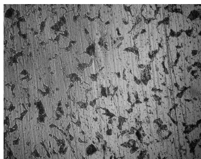
4.7/a. ábra. DuroTec 19910 szórt réteg. (500x)
