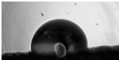
4.23. ábra. HardTec 19400 porötvözet beolvasztott felületén ülő vízcsepp
