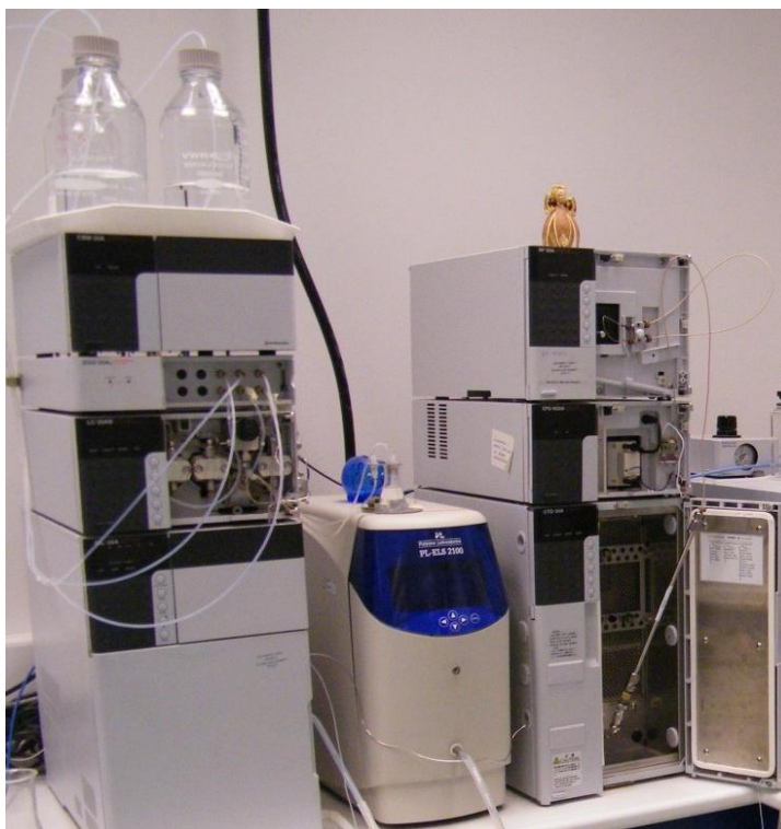
8. ábra a kutatott peptidek kromatográfiás meghatározása során alkalmazott Shimadzu LC-2010 HPLC rendszer és PL-ELS 2100 detektor kapcsolt rendszerben
