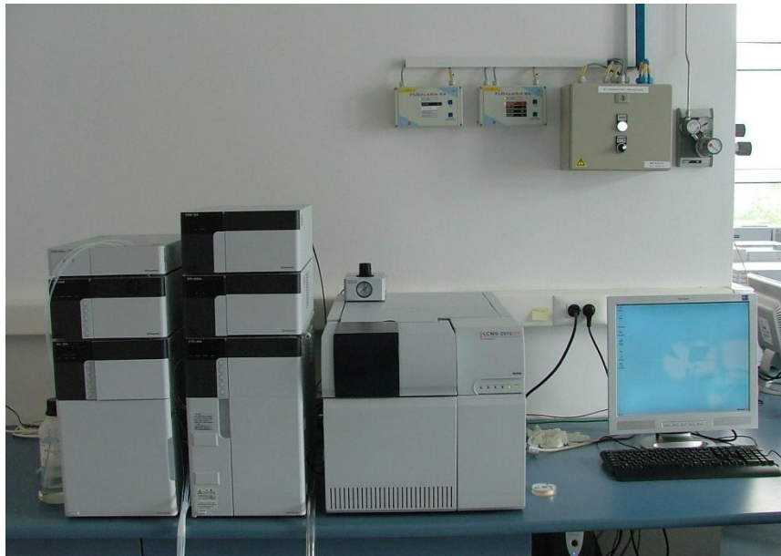
9. ábra a kutatás során alkalmazott Shimadzu LC-2010 folyadékkromatográf LC/MS 2010 detektorral kapcsolt rendszerben (forrás: saját készítésű fotó)
