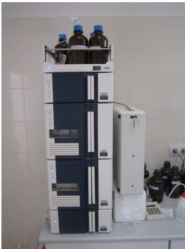
7. ábra Chromaster Hitachi 5430-as modellszámú nagyhatékonyságú folyadékkromatográfia
