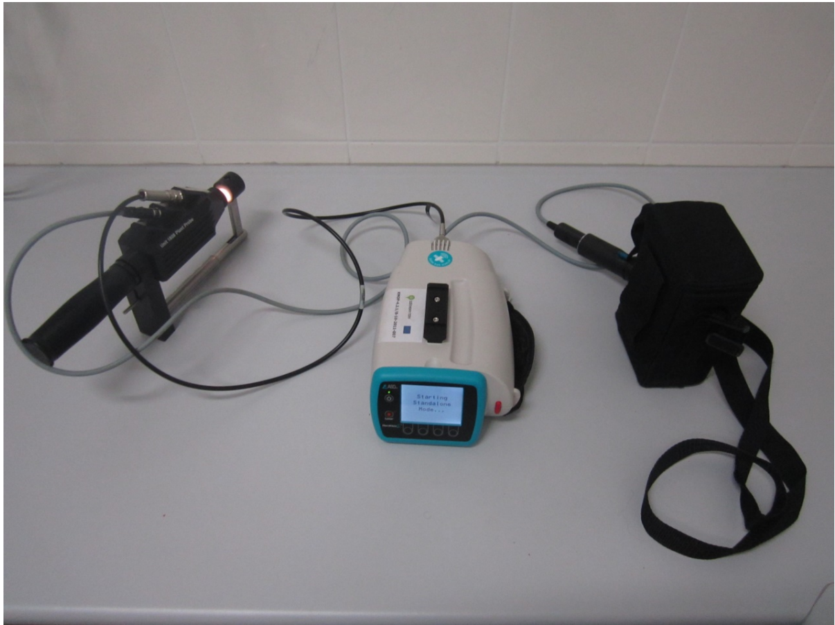
4. ábra FieldSpec HandHeld 2™ Portable spektroradiométer, a hozzá csatlakoztatott optikai kábellel, szondával, levélklipsszel és akkumulátorral.
