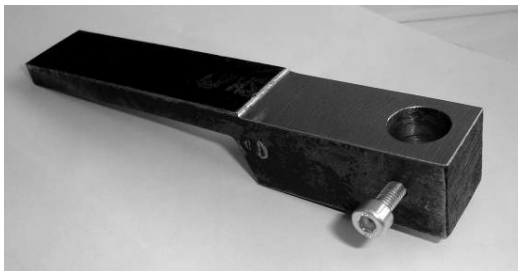
27. ábra Induktív útdát befogója
