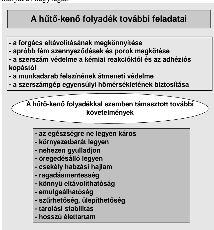
16. ábra A HKF-okkal szemben támasztott további feladatok és követelmények (Bartz et al. 2000)
