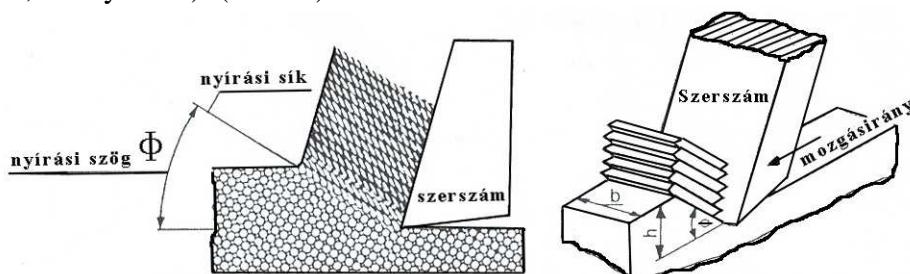
3. ábra A szabadforgácsleválasztás folyamata
