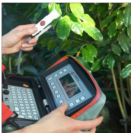
33. ábra AP4 porométer mérőfejének elhelyezése a levélen a transzspiráció méréséhez (http6)
