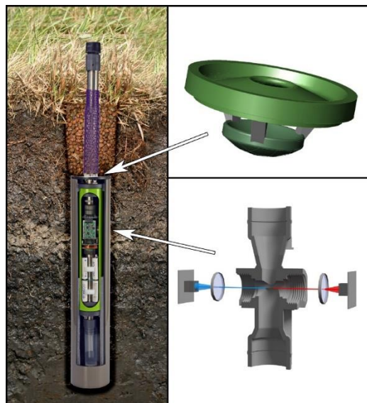
6. ábra EDAPHOLOG® típusú talajszonda szerkezete (forrás: DOMBOS et al. 2017 )
