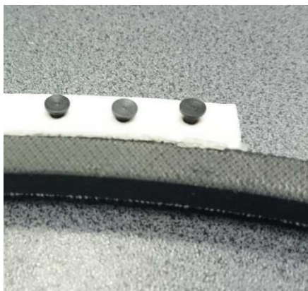
3.18. ábra Ékszíjon kialakított mérési pontok, és pozícionálása
