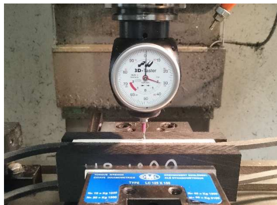
3.18. ábra Ékszíjon kialakított mérési pontok, és pozícionálása
