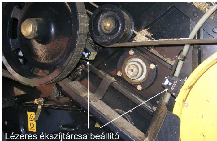
4.2. ábra Gabonabetakarító gép ékszíjhajtás-elrendezése
