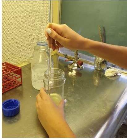
8. ábra Steril üvegbot segítségével 1 csepp steril desztillált víz szélesztése a táptalajon
