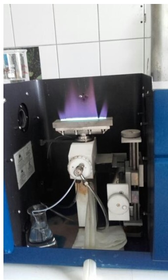
8. ábra. Aurora Trace AI 1200 atomabszorpciós spektrofotométer porlasztófeje.
