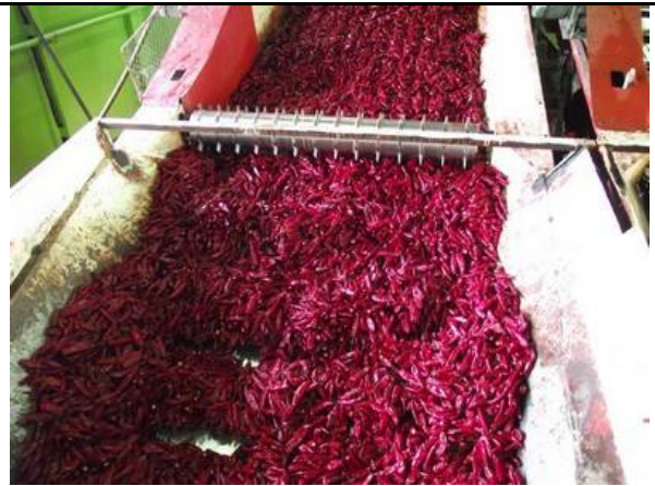
A szárítóüzem mosó berendezésének első szakasza
