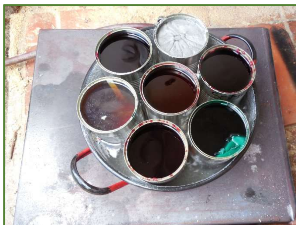
13. ábra: Vízfürdőben melegített, magas falú fémedényekben olvadó paraffintípusok
