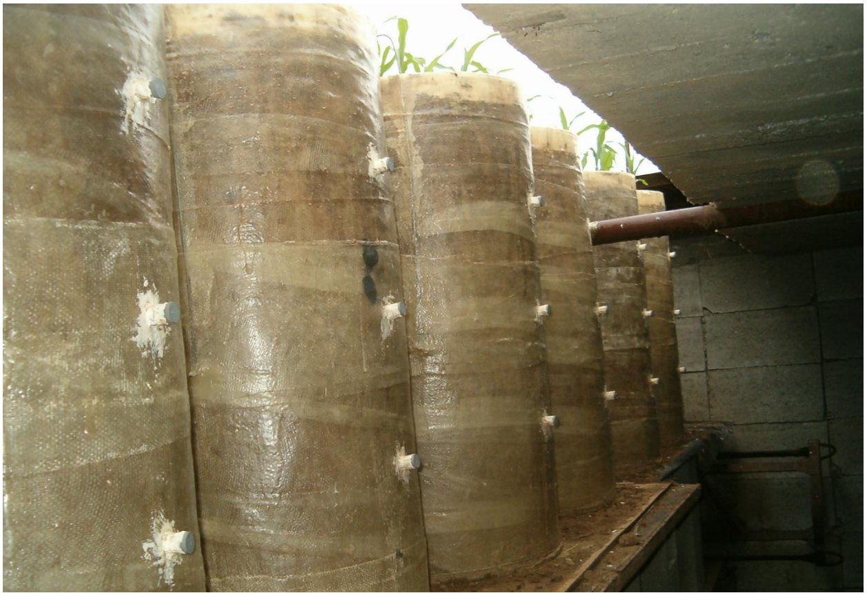
Talajoszlop kísérleti rendszer
