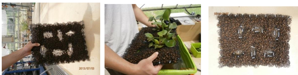
5.2.19. ábra – Az FCR reaktor vízinövényeihez fejlesztett keramzit párna
