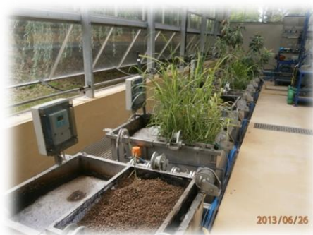
4.2.3. ábra – Telki, Kísérleti biológiai szennyvíztisztító rendszer
